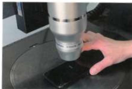
3D de zones millimétriques nécessitant une précision nanométrique. Avec ses 21,6 millions de points de mesure par seconde et une vitesse de balayage pouvant atteindre 36 000 lignes par seconde, le CHRcodile CLS 2.0 est parfaitement adapté aux
