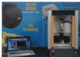
Elle se compose d'un plateau motorisé qui se déplace sur trois axes (XYZ), ce qui permet de venir scanner toute surface qui nous intéresse. Le scan XY permet de scanner dans deux axes une surface graduée qui renvoie
