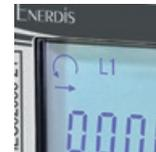
Mesure dans les 4 quadrants avec indicateur de balance énergétique
