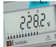
Ecran LCD haute lisibilité avec des angles de vue de 120° en vertical et en horizontal
