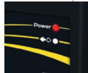
LED COM : échanges de données (clignotante au rythme de la transmission RS485)
