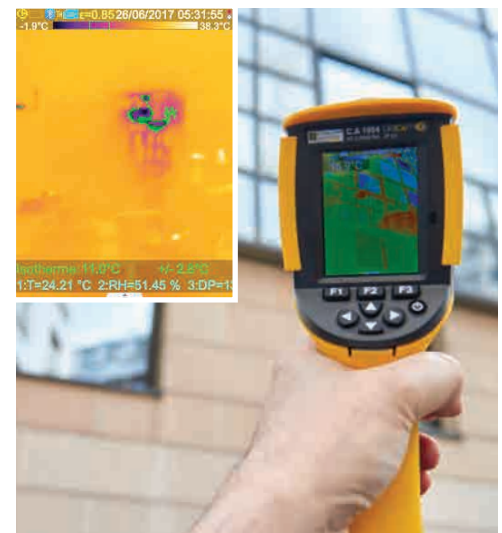
CAMERA C.A 1954 DIACAM2 L'ISOTHERME COUPLÉ À LA VALEUR DU POINT DE ROSÉE PERMET DE DÉTECTER LES ZONES À RISQUES DE MOISSISSURES
