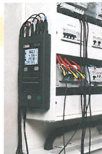
Enregistreur de puissances communicant multicanal PEL.
