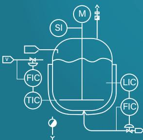
✓ **Contrôle de température de réacteur avec contrôle débit fluide caloporteur double enveloppe**
